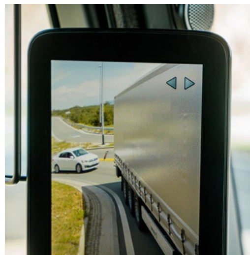
Oben: Die MirrorCam ist das Erkennungszeichen des neuen Actros. Unten links: Abstandslinien helfen beim Blick auf den rückwärtigen Verkehr. Unten rechts: Beim Abbiegen schwenkt die Kamera mit.
