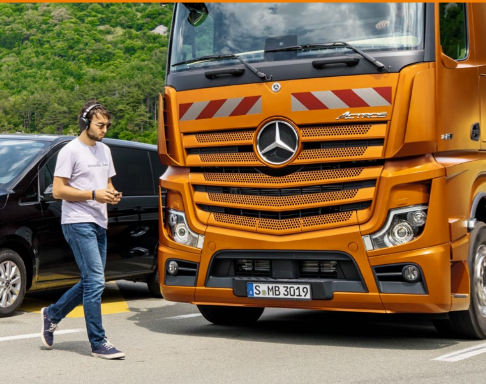
Links: Der Active Brake Assist des Actros erkennt Personen, die unachtsam die Fahrbahn überqueren.
